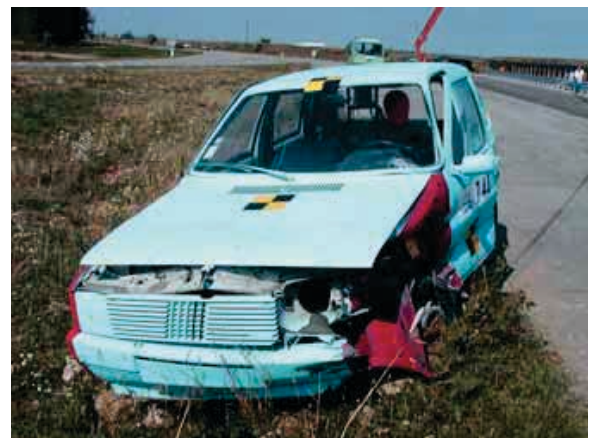
Figura 2 - Deformación del vehículo TB11
